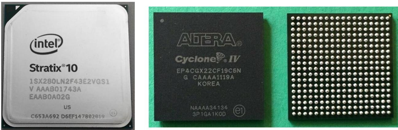
Figura 226 - Exemplos de FPGA.
