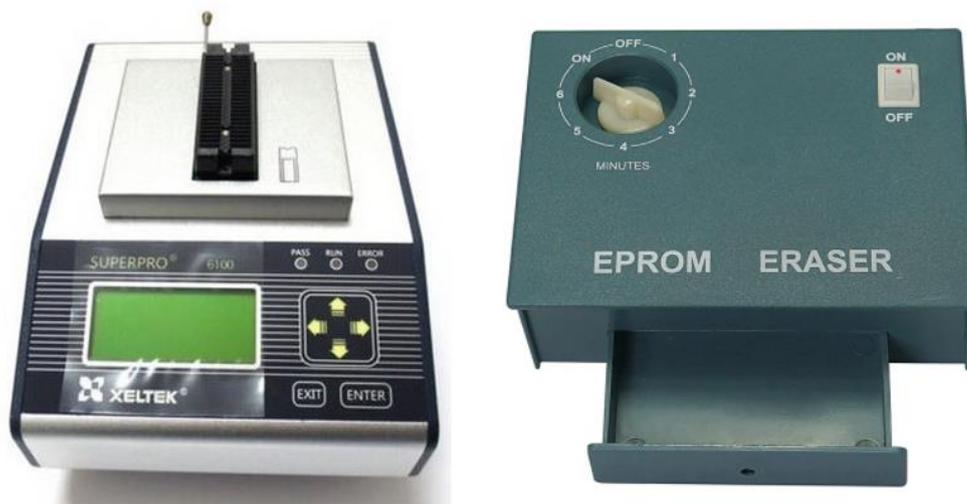
Figura 199 - Equipamentos para gravar e apagar memórias EPROM.
