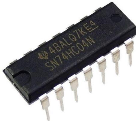
Figura 48 – Circuito integrado da porta lógica inversora.
